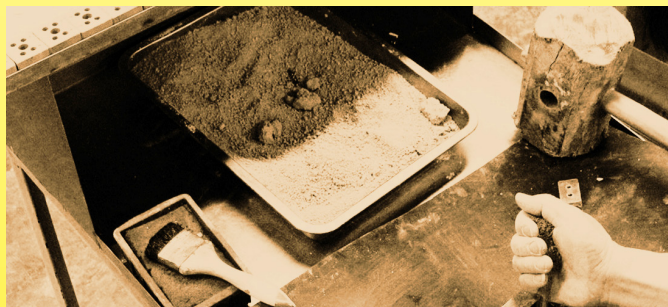
高频瓷端子接线柱手工锤子压制；手动填充湿的颗粒（私人收藏）。压制后电高频瓷的干化（私人收藏）
